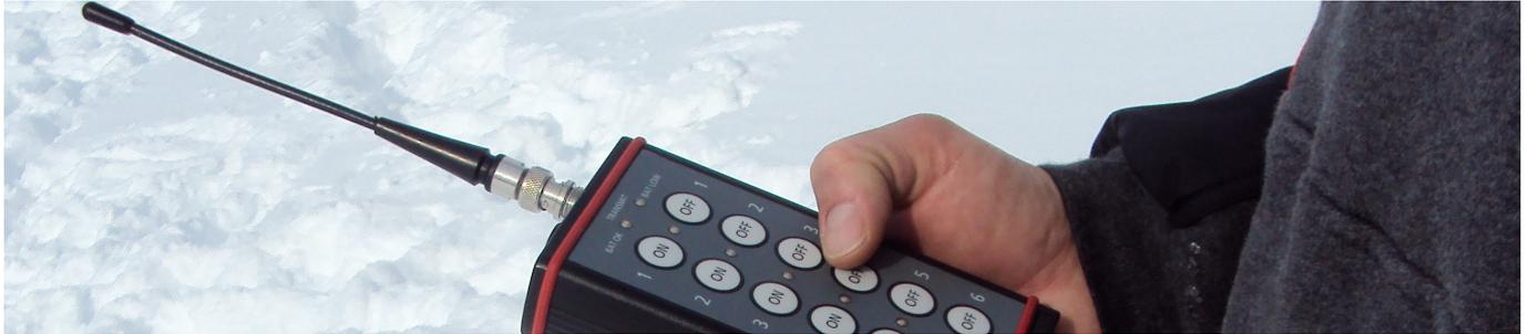
Le système d'entraînement mobile RTX457 est un équipement robuste avec indication des touchés par sondage. Le système est disponible avec 4 ou avec 6 émetteurs DVA. Il peut être utilisé pour la formation et pour le test d'appareils.
